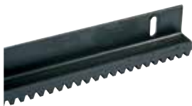
ACS9050 CREMALLERA M4 de acero (sec. 22 x 22 mm) tratada con CATAFORESIS, con angular 45 x 30 mm (hasta 4.000 Kg) en barras de 2 m al m
